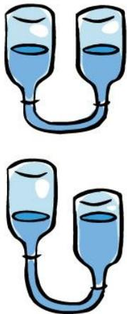
Dans deux récipients reliés entre eux par le fond, le niveau de liquide est toujours identique. L'eau contenue dans le château d'eau situé au point le plus haut du circuit de distribution peut ainsi monter naturellement jusqu'aux derniers étages des immeubles.
