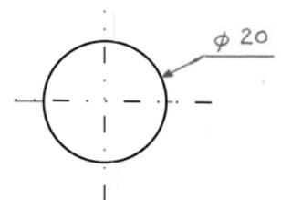
Le symbole  $\varnothing$  correspond au diamètre du trou. Ici diamètre 20 mm
